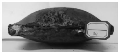
图11 界面四周焊合抽真空板坯加热后的鼓包形貌 [43]
