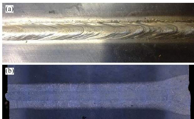
(a)表面形貌;(b)焊缝横截面 图12 电子束焊接的S355壳体形貌 [47] Fig. 12 Circumferential EBW of a S355 shell
